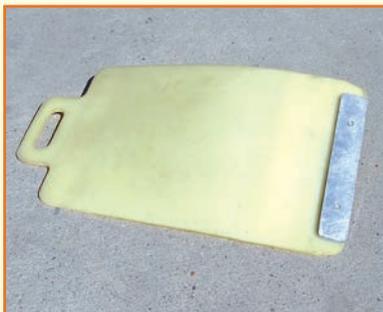
Beim Einrütteln von Pflaster wird der Einsatz einer sogenannten Vulkollanplatte empfohlen. Sie schützt die Steinoberflächen, Ecken und Kanten von Betonsteinen oder Klinkerplatten. Diese platzen dann nicht mehr so leicht ab.
