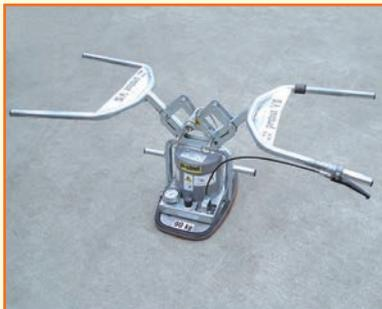
Kraftvolles Vakuumgebläse saugt stark poröse Plattenbeläge sowie auch Waschbetonoberflächen sicher und kraftvoll an. Viele Arten von Platten lassen sich schnell und fugenlos verlegen.
