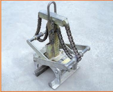
Geeignet zum Greifen und Versetzen von Betonfertigteilen, Trittstufen und Bordsteinen
