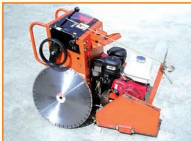
Robuster, präziser Fugenschneider für Schnitte in Beton und Asphalt. Rechtsschnitt, Vorschub: Handrad; Aushub: handhydraulisch. Aufklappbarer Blattschutz für schnellen Blattwechsel, eingebauter Kranhaken.
