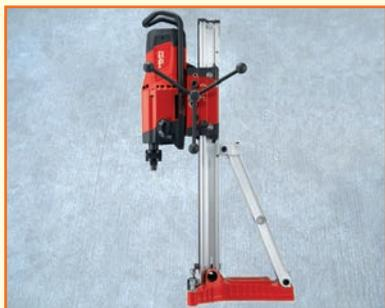
Ständergeführtes Kernbohrgerät zum Nassbohren in Decken, Wänden und Böden sowie Durchbrüche für Leitungen, Rohre etc. Kompakte Bauform und einfache Bedienelemente.
