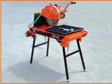
Leistungsfähige, bedienerfreundliche Tischsäge für den Nassschnitt zum Trennen von Pflastersteinen, Platten, Borde, Klinker etc. Die Tischsäge von NORTON garantiert sicheres Trennen, präzise Schnitte und saubere Führung. Stabiles Untergestell und großer Auflagetisch. Die Wasserpumpe wird mittels einer Steckverbindung befestigt. Abholung mittels PKW -Kombi, Anhänger, Caddy oder Transporter möglich. Lieferung wird angeboten gegen Aufpreis.
