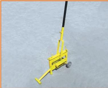
Mechanischer Einhebel-Steintrenner für alle normalen Einsatzzwecke. Trennen von Verbundsteinpflaster, Klinkern oder Bordsteinen aus Beton. Selbstabholung mit PKW möglich.
