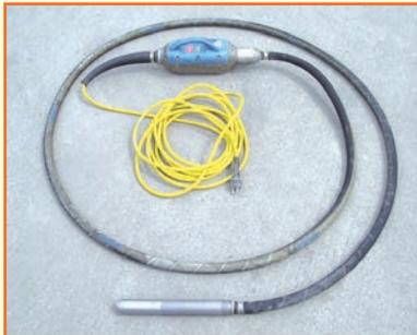
Hochfrequenz-Innenvibrator mit integriertem Frequenzumformer. Anwendung für die Betonverdichtung im Hoch- und Tiefbau, bei Schalungen, Fundamenten, Säulen, Wänden, Pfeilern in hoher Qualität und großer Verdichtungsleistung. Wirkungsdurchmesser bis 50 cm, je nach Konsistenz.
