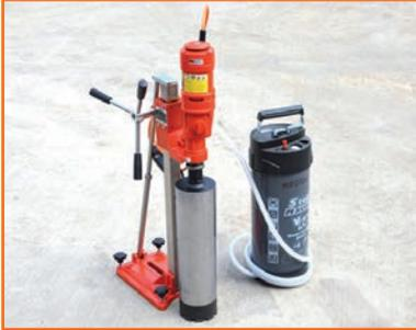
Leistungsfähiges, bedienerfreundliches Nasskernbohrgerät für kleine Bohrbereiche. Handgeführte als auch ständergeführte Bohrungen möglich. Das DK 17 eignet sich hervorragend zum Bohren von armiertem Beton und Mauerwerk.
