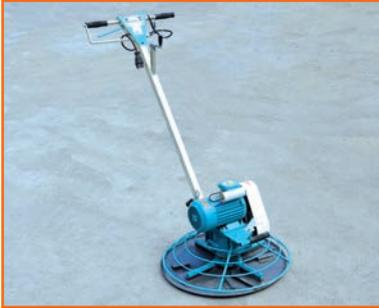
Zum Abscheiben und Glätten sowie Schleifen von Beton und Estrichböden.
