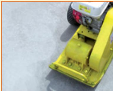
Vielfältige Einsatzmöglichkeiten für kleine Verdichtungsarbeiten. Zum Verdichten von Boden und leichten Baustoffen im Straßen- und Landschaftsbau. Tiefenwirkung 20 - 30 cm, Steigfähigkeit bis 30 % je nach Bodeneigenschaften. Ausstattung mit bedienerfreundlichem und zuverlässigem HONDA-Benzinmotor mit Seilzugstart. Selbstabholung mit PKW möglich, durch kleine, kompakte Bauweise. Mit umklappbarem Bügel ausgestattet.
