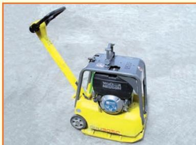
Mittelschwere, wendige Allroundmaschine für vielfältige Einsatzmöglichkeiten im Straßen-, Garten- und Landschaftsbau. Zum Verdichten von Gräben, Gehwegen, für flächenmäßige Instandhaltungen sowie für mittlere Pflasterarbeiten.
